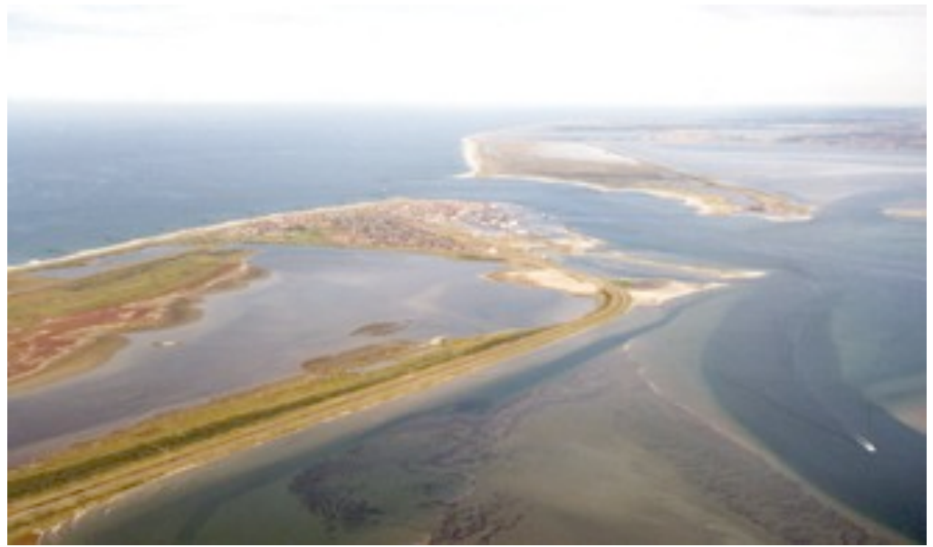
Fotoet viser Thyborøn Kanal og Agger Tange i baggrunden. Til venstre ses de mange høfde, der er anlagt ud for byen og langs stranden. Nedenfor ses havnen. Foto og tegning: Kystdirektoratet.
